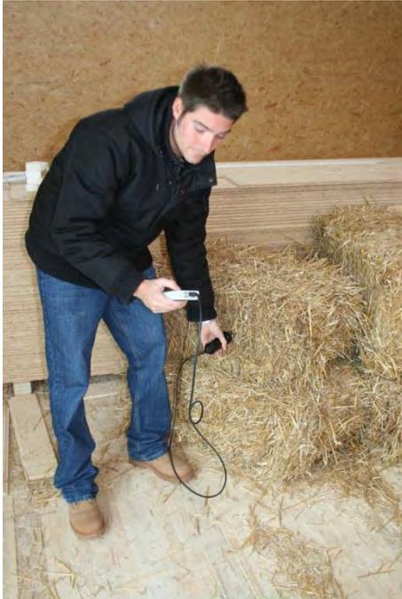
Abbildung 41: Messung der Materialfeuchte (Quelle: GrAT)
