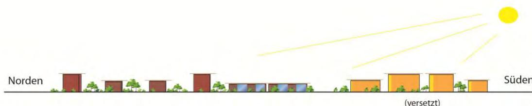
Abbildung 36: Längsschnitt, Wohnbauten nach solarthermischen Gesichtspunkten ausgerichtet (Quelle: GrAT)
