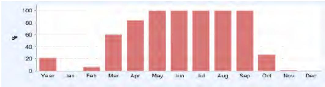
Abbildung 67: Solarer Deckungsgrad (Quelle: GrAT, erstellt mit Polysun)
